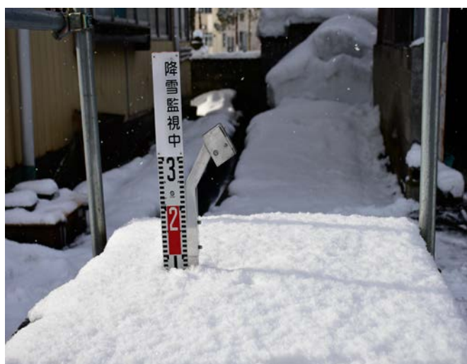
写真1 除雪自動通報装置
