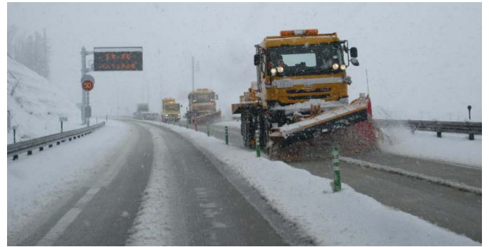
写真-2 除雪トラックによる作業状況
