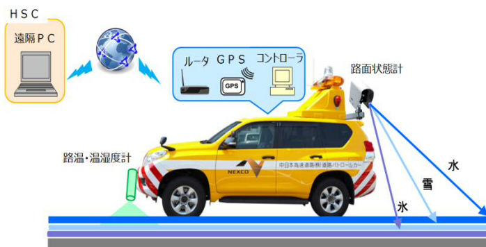
図6. 車載路面状態計の構成
