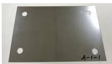
写真6. 金属試験片 (67×10×0.3mm)
