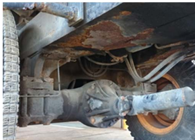
写真3 車体の著しい腐食状況
