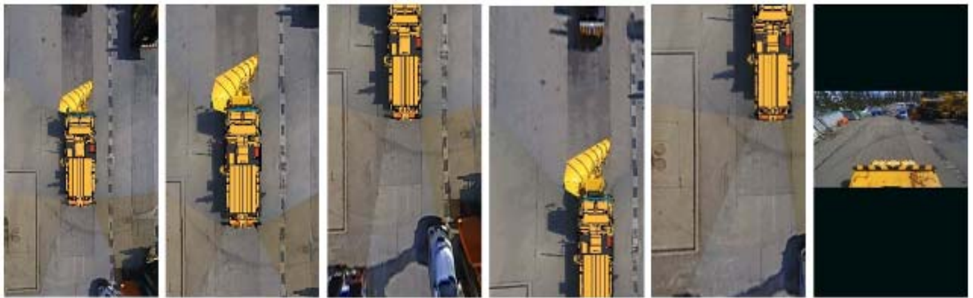
モードA (SA・PA) モードB (構内・TB) モードC (除雪・剤散布作業) モードD (前方除雪作業) モードE (後方除雪作業) モードF (後方確認)
