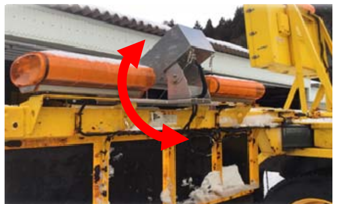
写真6. 調整部分の改善部
