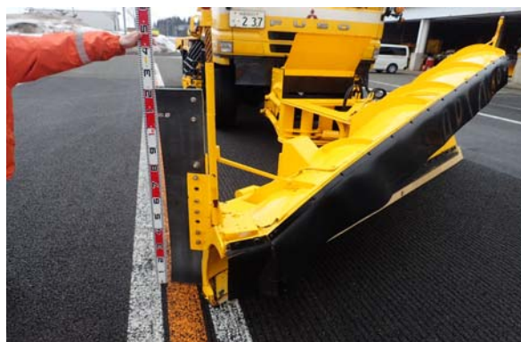
写真-6 ゴム板方式
