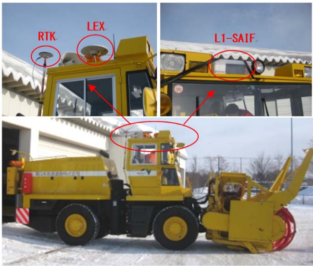
写真2 ロータリー車アンテナ搭載状況
