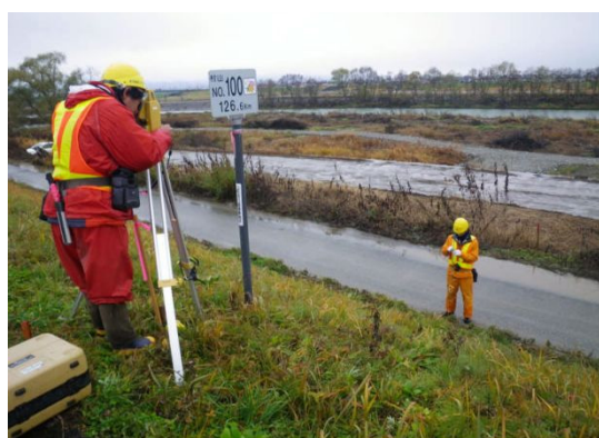
河川横断測量の様子
