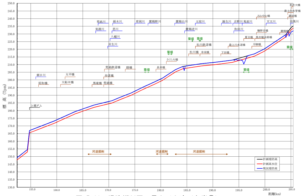
図 5-11 堤防縦断面図 最上川上流 (右岸②)
