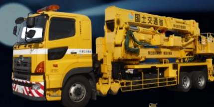
橋梁点検車(バケット式)
