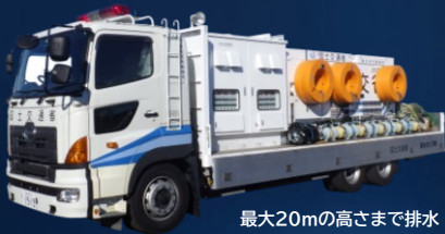
排水ポンプ車(60m 3 /min,高揚程型)
