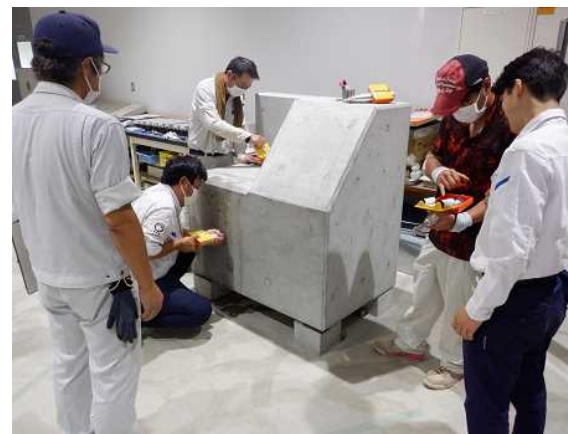
非破壊検査(テストハンマー)体験
