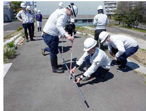
堤防の抜け上がりの計測
