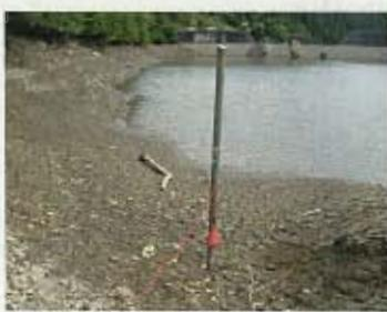
水位計(フロート式)設置状況
