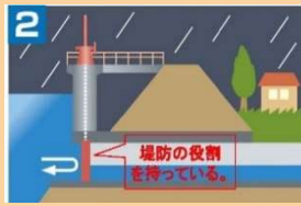
②川の水が住宅地や田んぼに流れてくるのでゲートを閉めます。
