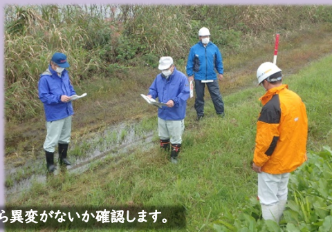
イタドリが群生している箇所に貫入棒をさし、その深さを確認することで堤防の土の強度を点検します。
