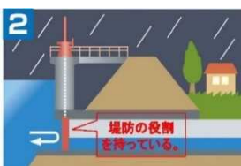
②川の水が住宅地や田んぼに流れてくるのでゲートを閉めます。
