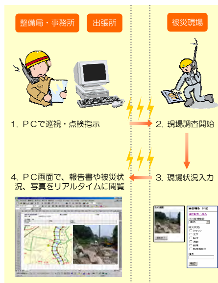
図 5-28 河川巡視点検システムのイメージ
