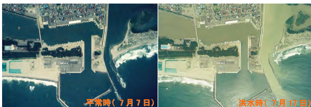
図 5-22 平成 14 年 7 月洪水時の河口砂州の変化
