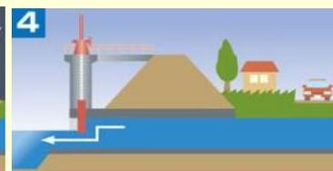
①平常時は、樋門の門扉は開いており、生活排水や雨水が川へ流れています。しかし、②大雨等により河川の水位が高くなると、川の水が樋門を通じて住宅側に流れ込み（逆流）、浸水被害が発生するため門扉を閉めます。③門扉を閉めると、住宅側の水の行き場がなくなり浸水被害がおこる場合があります。（排水機場運転や排水ポンプ車等で対応します）④河川の水位が低くなり、住宅側への逆流の心配がなくなったら、門扉を開けて排水します。
