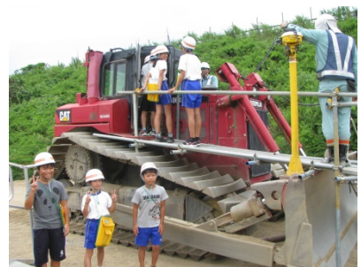
あとどれくらい削ればよいか画面に表示されるブルドーザー
