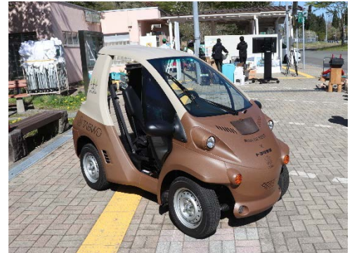
秋田スギの木粉を用いた外装パーツを施した「もくまる」
