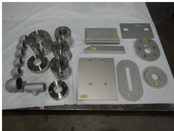
⑩内川流域堰ゲート設備災害復旧工事 材料確認中
