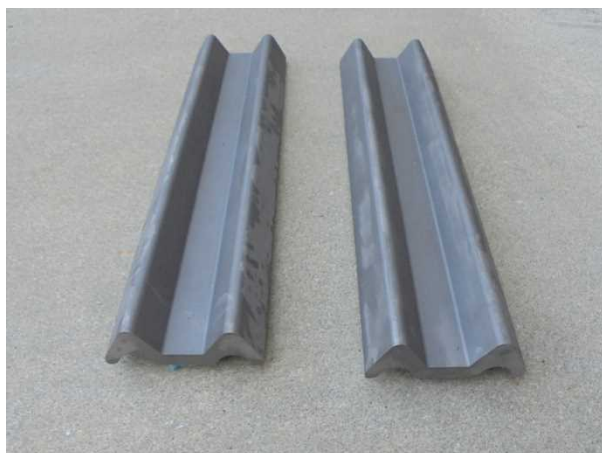
⑩内川流域堰ゲート設備災害復旧工事 固定金具制作状況
