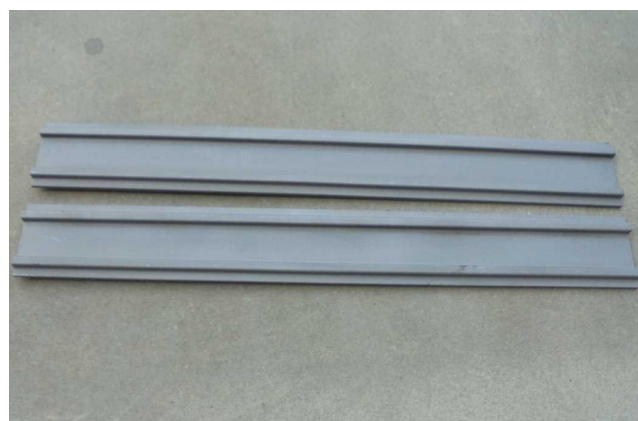
⑩内川流域堰ゲート設備災害復旧工事 固定金具制作状況
