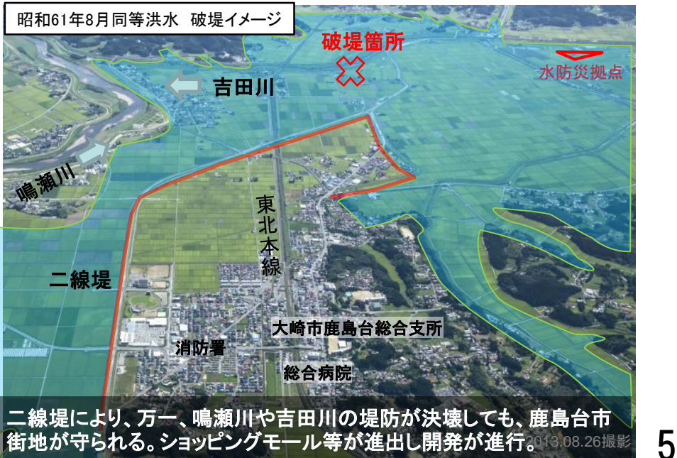
昭和61年8月洪水では、吉田川で4箇所での堤防が切れ、鹿島台では11日間も浸水するなど、甚大な被害を受けた。
