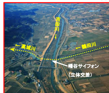
吉田川、鶴田川、高城川と幡谷サイフォン (品井沼流域を鳴瀬川流域から分離)
