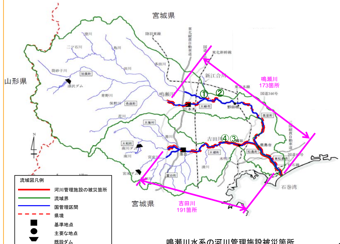
鳴瀬川水系の河川管理施設被災箇所
