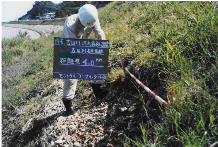
洪水痕跡調査の状況（吉田川右岸）
