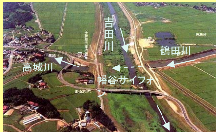
洪水防御のため、幡谷サイフォンにより品井沼流域を分離
