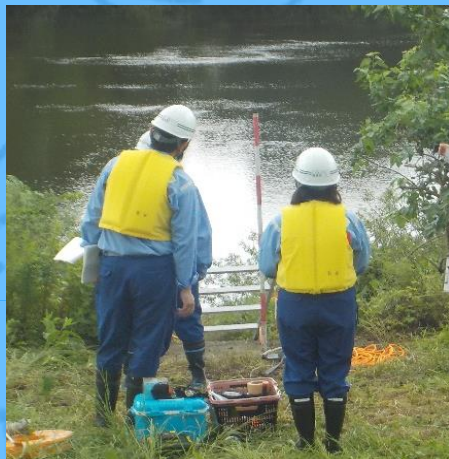
洪水時の流量観測（高水流量観測）
