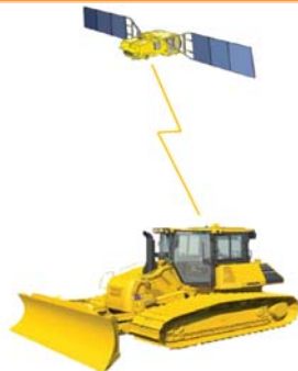
ICT建設機械では図面を案内してくれる
