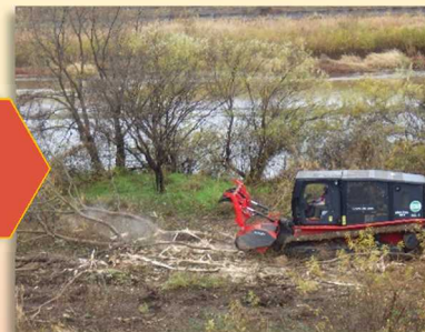
樹木を押し倒して破碎、木くずと土砂を攪拌
