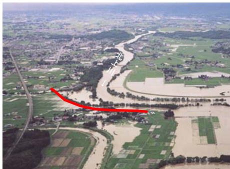
北上市甘木地区での輪中堤による治水対策
