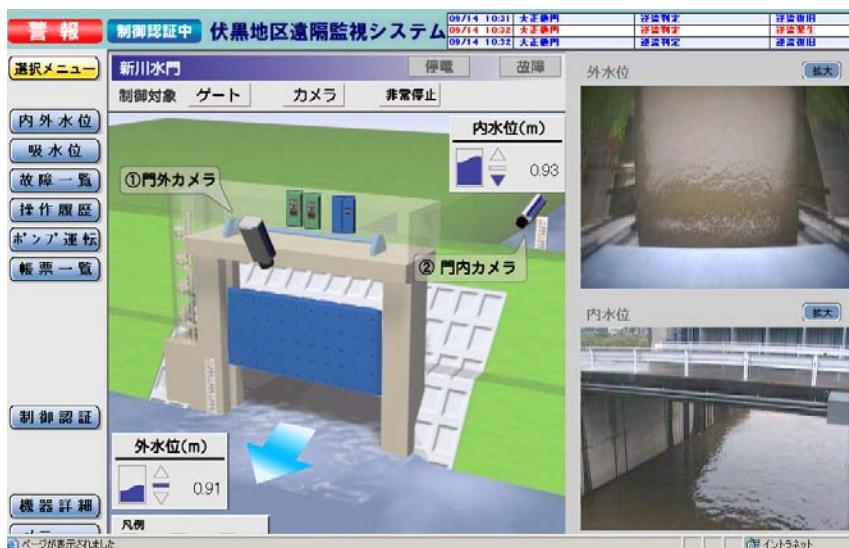
図 5-3-1 河川管理施設の遠隔監視システム
