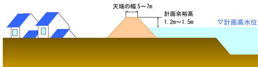
図5－1 堤防整備のイメージ(無堤箇所における堤防の新設)
