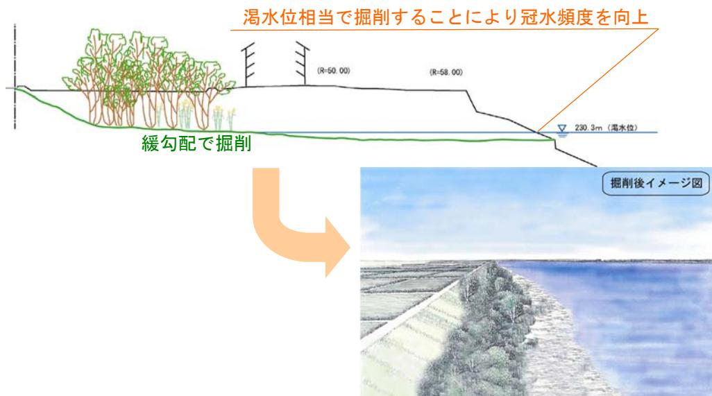
図5－17 外来種の侵入に配慮した河道掘削の検討例（須賀川市）
