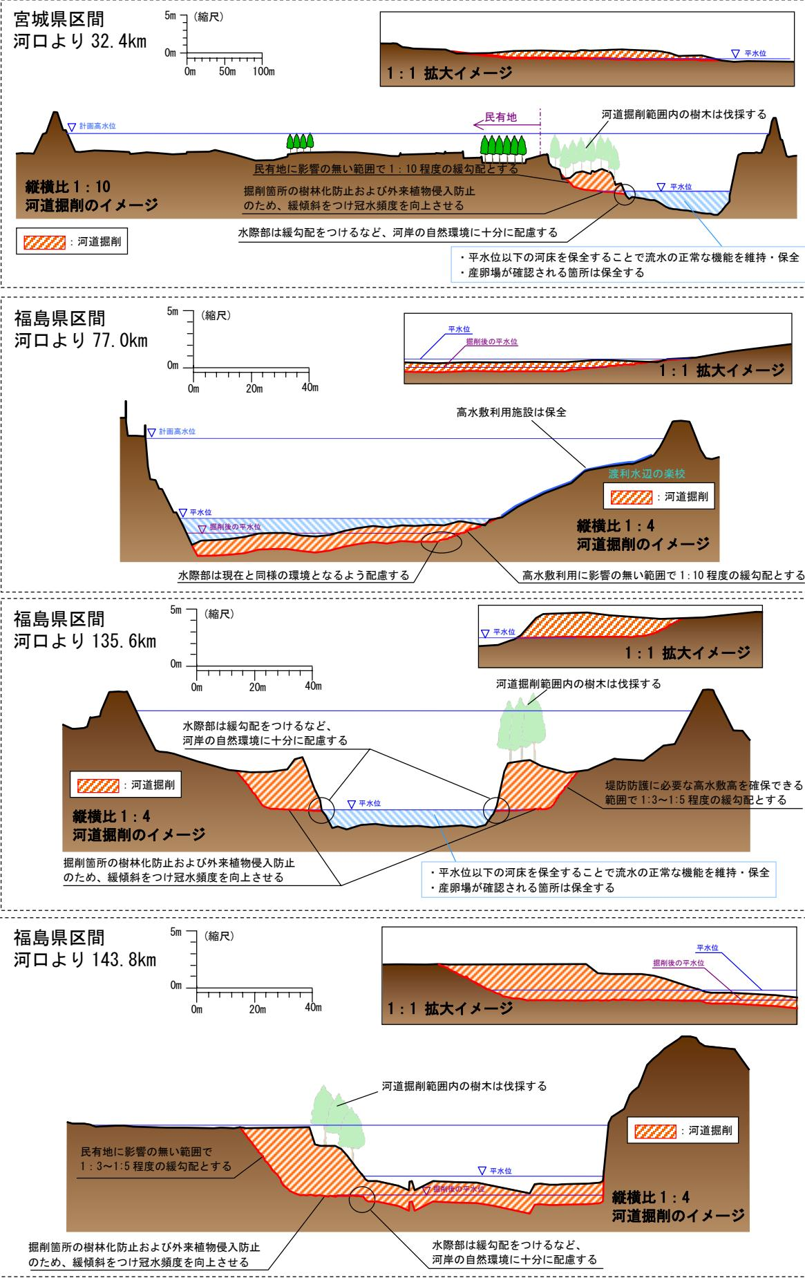
図 5-10 河道掘削のイメージ図
