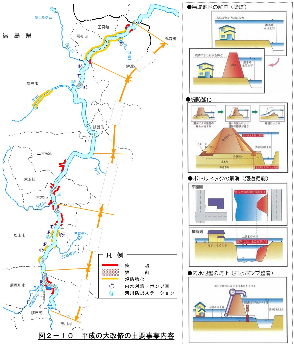
※1. 平成の大改修：阿武隈川上流(福島県区間)の河川整備率の抜本的向上と整備効果の早期発現を図ることを目的に、河川改修事業（「一般河川改修事業」「床上浸水対策特別緊急事業」「救急内水対策事業」など）と災害復旧事業（「直轄河川災害復旧事業」「直轄河川災害関連緊急事業」など）を総合的に短期間に集中実施。
