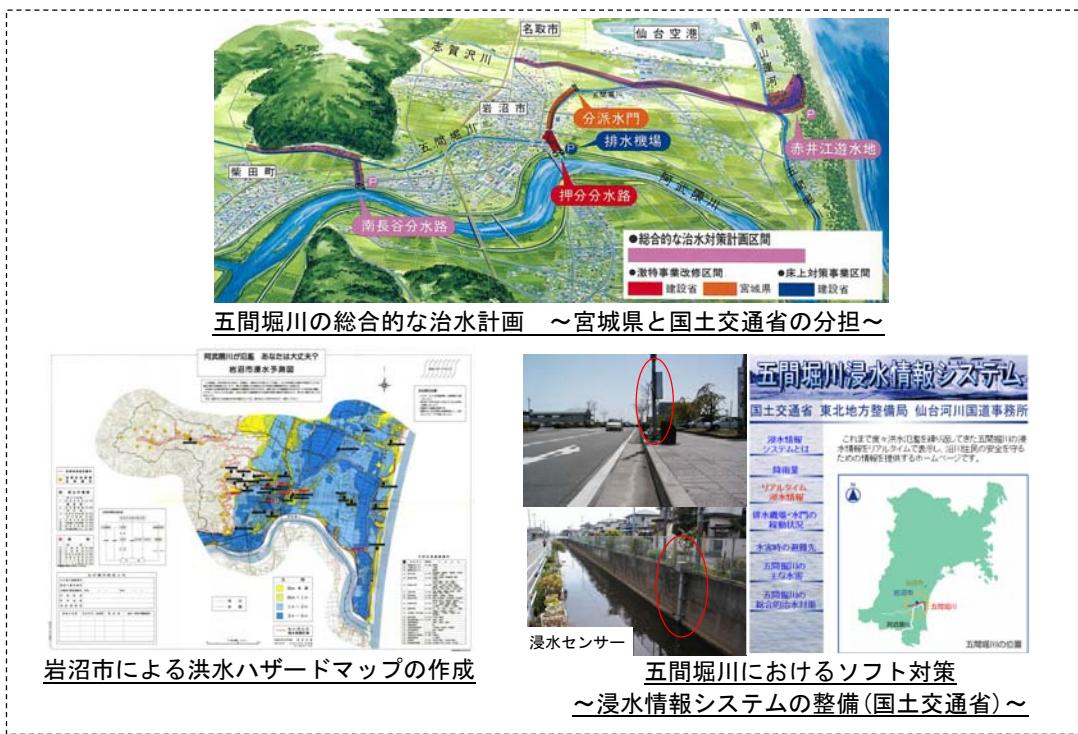
図5－13 国と地方が連携した総合的な治水対策(五間堀川)
