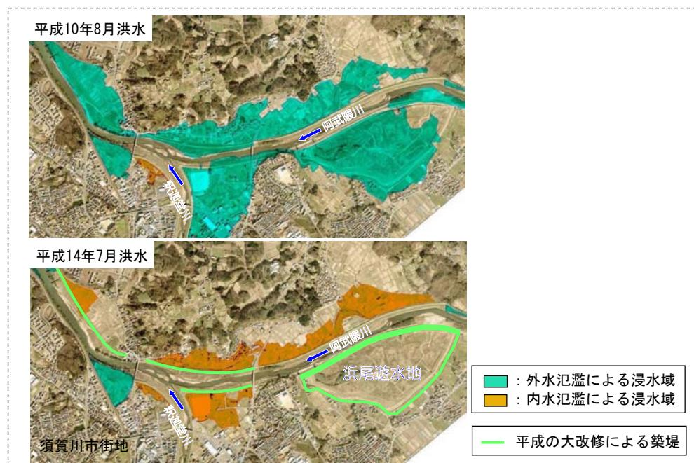
図3－8 内水被害の顕在化の例【須賀川市】
