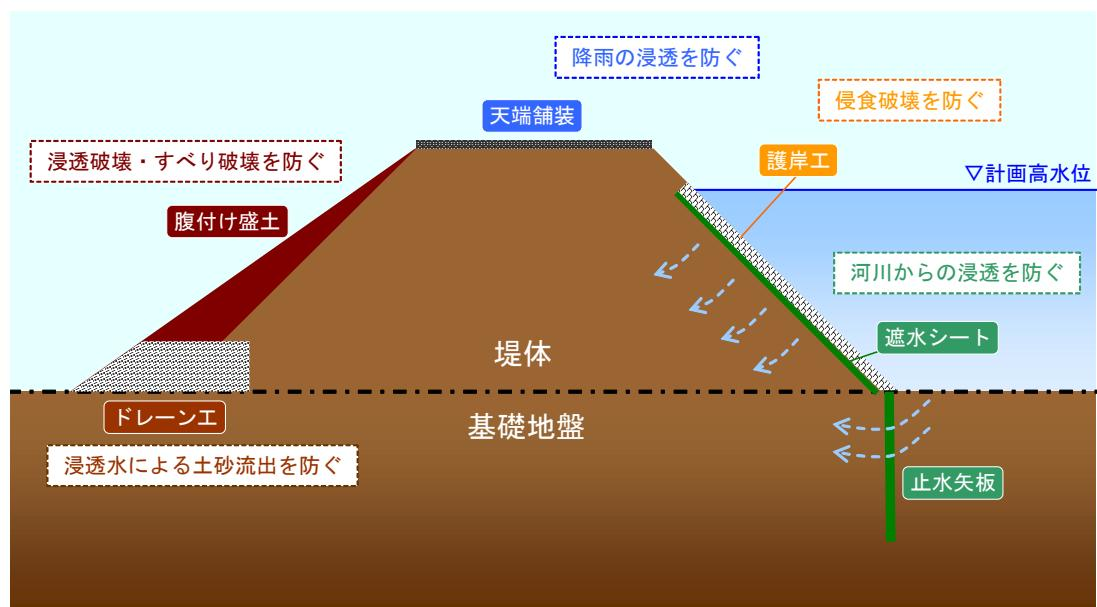
図 5－5 堤防の質的整備断面イメージ
