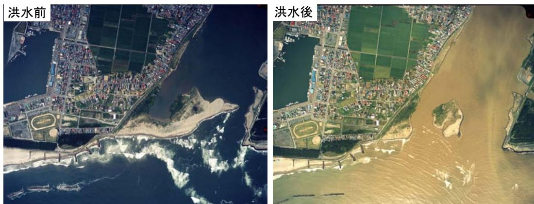
平成 14 年 7 月洪水による河口砂州の変化
