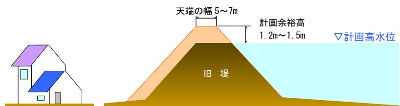
図5－2 堤防整備のイメージ(断面不足箇所における堤防の拡築)
