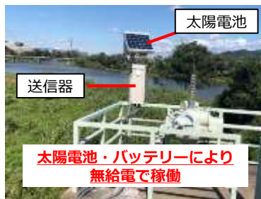
危機管理型水位計設置イメージ
