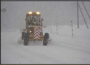
除雪グレーダによる作業状況
