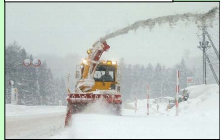
ロータリ除雪による作業状況
