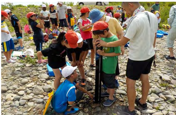
「透視度計」を用い、川の水の透明度を調査
