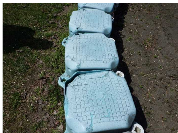
不具合箇所(ベンチ座部の破損) 撤去済み
