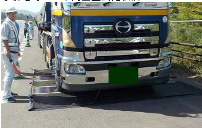
○新地町での車両重量測定状況
