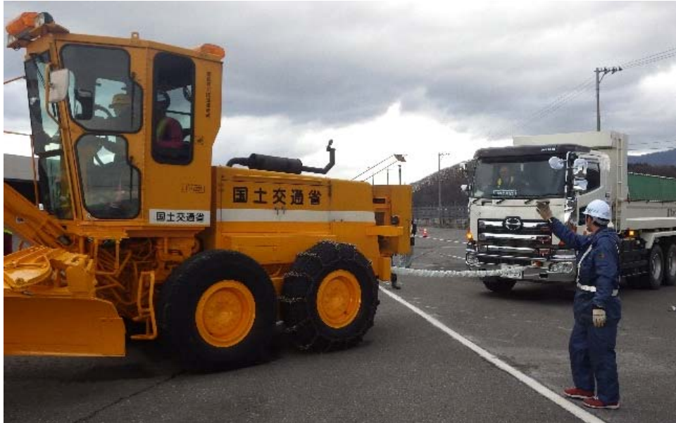
▲車両を塞ぐ大型車をけん引
