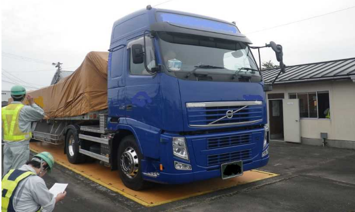
○名取車両検測所での車両重量の測定状況
