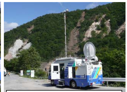
衛星通信車(H20 岩手・宮城内陸地震)
