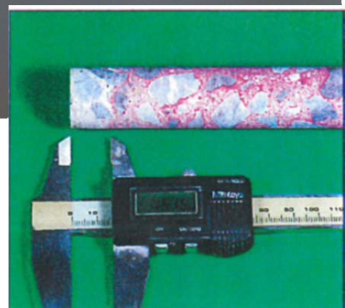
中性化深さの測定状況
