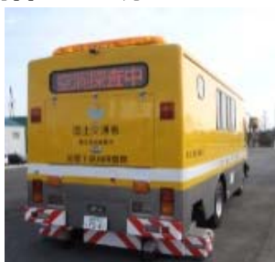
【路面下空洞調査】
