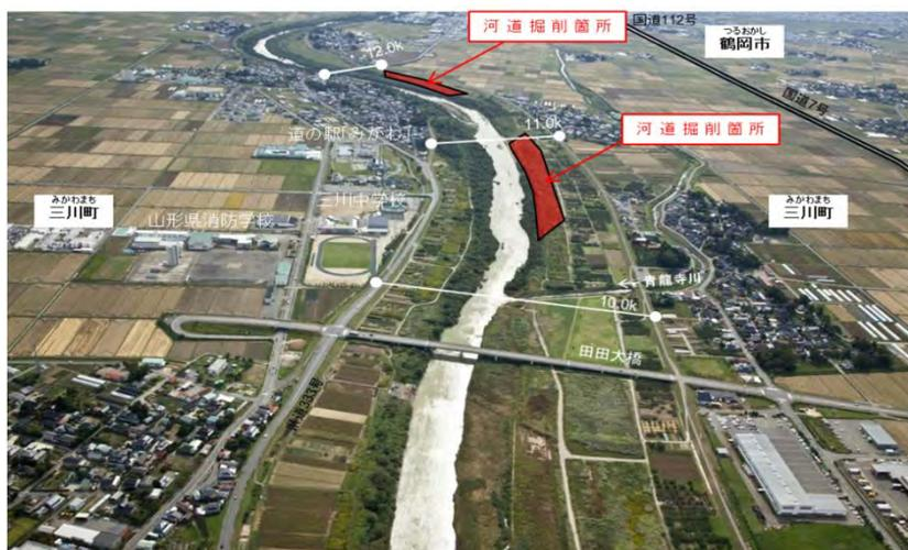
平成27年度は、ひきつづき河道掘削を実施し、治水安全度の向上を図ります。
