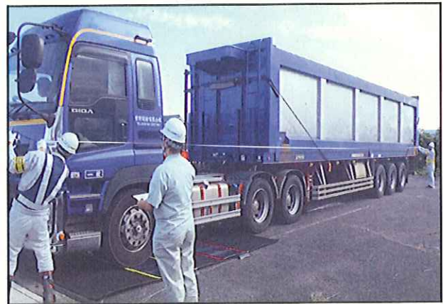
・重量及び車両の寸法を測定、違反がないか確認
