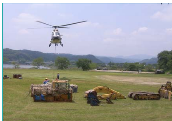
▲ヘリコプターによる空輸事例 油圧ショベル0.5m 3 （岩手・宮城内陸地震）
