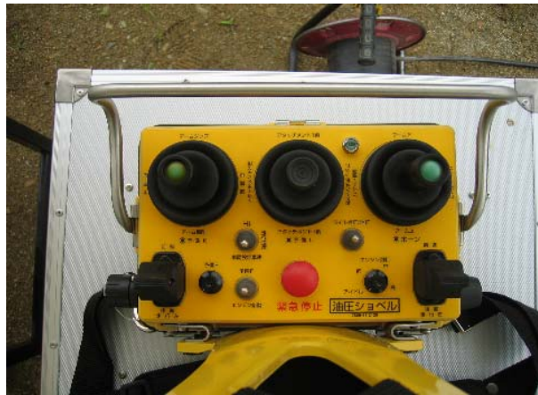
写真-3 ラジコン装置
