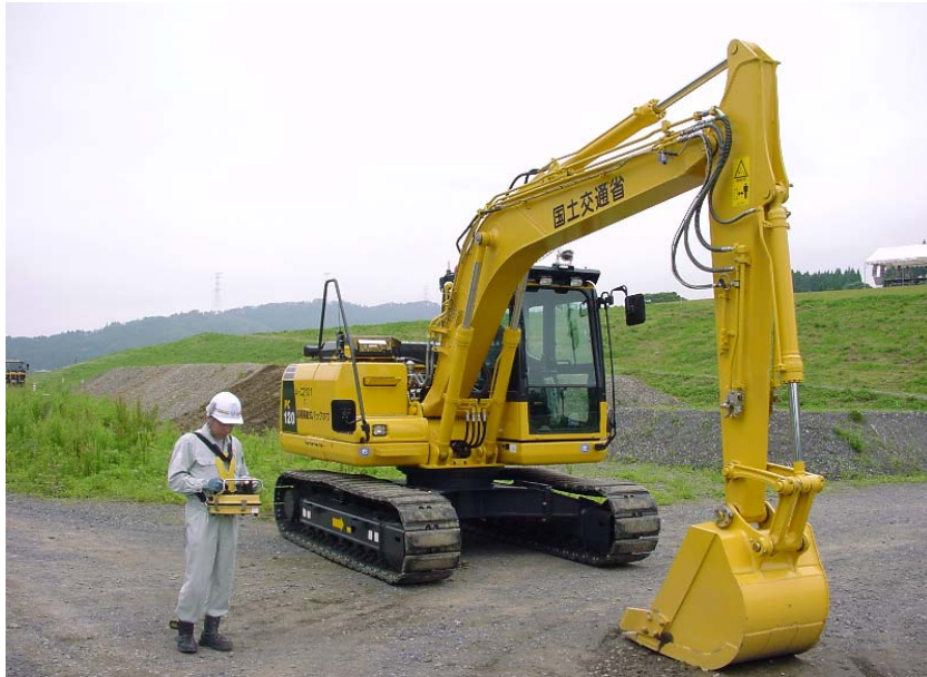
写真-1 遠隔操縦式油圧ショベル(0.5m 3 )全景
