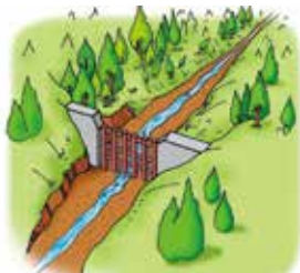
②透過型砂防堰堤を設けた場合でも、普段は、水と土砂は同じように下流に流れていきます。
