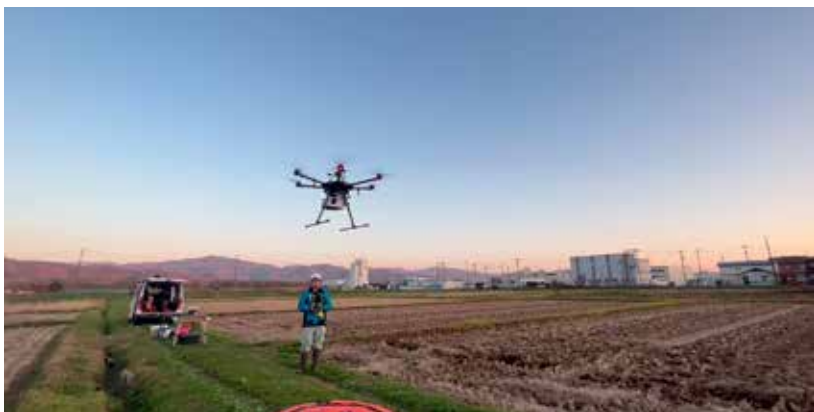
UAVによる路線測量(盛岡南道路)
