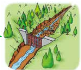
④堰堤にたまった岩、土砂や流木は、次の土石流に備えて取り除きます。
