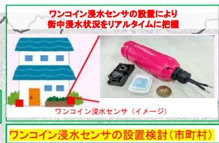
ワンコイン浸水センサの設置により、家中浸水状況をリアルタイムに把握
