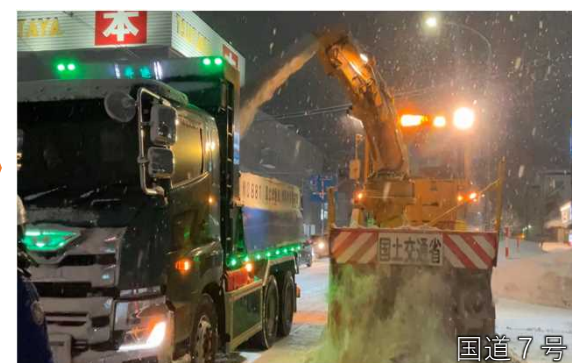
③ロータリー除雪車でダンプトラックに積み込み
