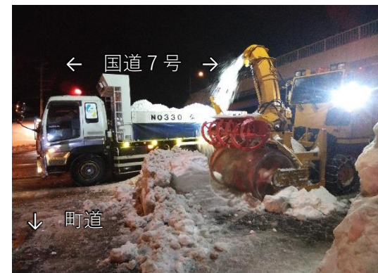
③ロータリー除雪車でダンプトラックに積み込み
